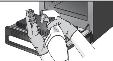
4. 将经批准的 Merrychef 清洁剂喷涂到海绵上, 并用海绵清洁腔体顶部 (喷气板) 和门密封件外的所有内部表面。
