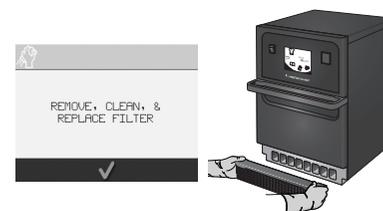
9. 更换炉盘并关闭门。拆掉空气过滤器, 并在肥皂水中清洁或清洗。干燥并更换, 然后按屏幕上的对勾标记继续。
