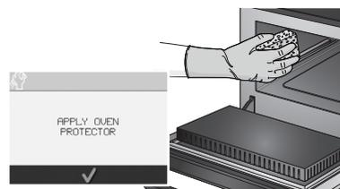
8. 涂抹烤箱保护剂 (可选)。用海绵将保护剂轻轻涂抹在除腔体顶部和门密封件外的所有内部表面上。按屏幕上的对勾标记继续。
