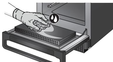
6. 用干净的湿布清洗所有表面。如果必须去除食物残渣, 腔体顶部和门密封件也可以用干净的湿布擦拭, 但不需要定期进行清洁。
