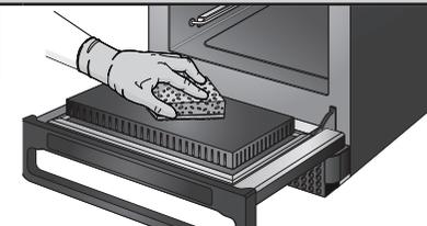
5. 对于难以清洁的区域, 可在设备门打开的情况下浸泡 10 分钟, 然后使用无磨料尼龙擦洗垫。
